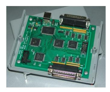
Для такой системы разработана система сбора информации MARS-10T2 на основе программированной логики, интегрированной с системой отбора данных двойных совпадений с максимальным числом каналов 24&24=596.
