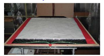
Мюонный телескоп ОРТО площадью 4 м<sup>2</sup> создан на базе оптоволоконных сцинтилляционных детекторов, комбинированных с нейтронным монитором.
