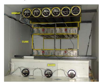
Если же объединить счетчики парами, то для такого телескопа можно реализовать m=16 независимых совпадений и n=9 независимых направления прихода частиц.
