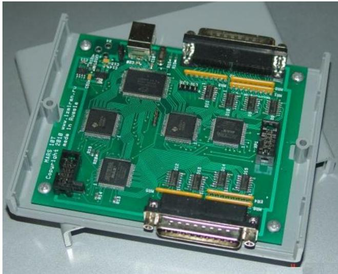
Для такой системы разработана система сбора информации MARS-10T2 на основе программируемой логики, интегрированной с системой отбора данных двойных совпадений с максимальным числом каналов  $24 \times 24 = 596$ .
