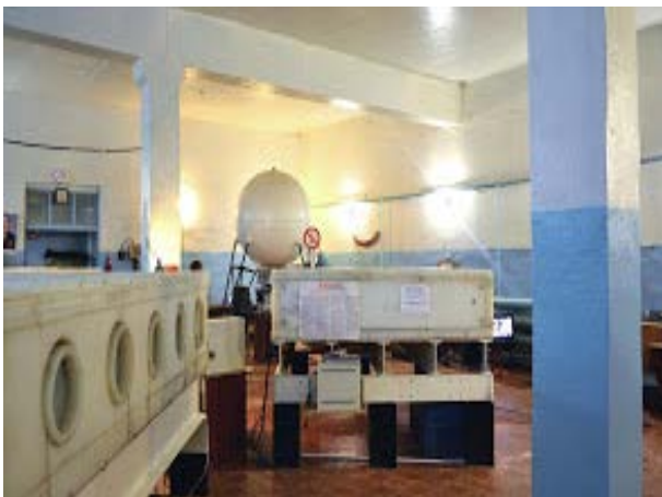
Слева-направо: секции В и С нейтронного монитора 18NM64. На заднем плане видна ныне неработающая большая ионизационная камера АСК-1.
