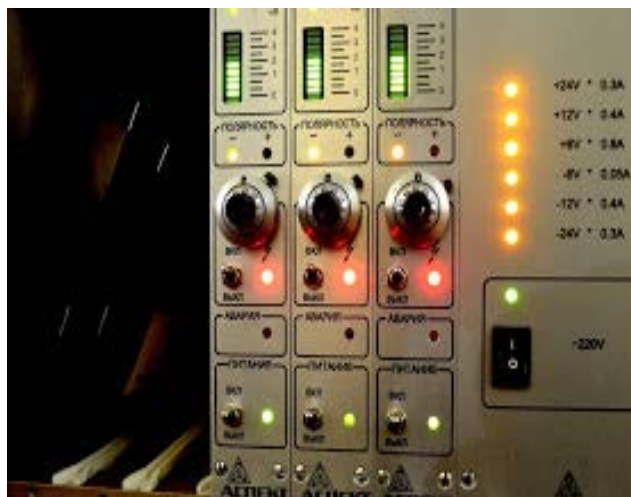
Источники высокого напряжения БНВ-05 — по одному на каждую секцию.
