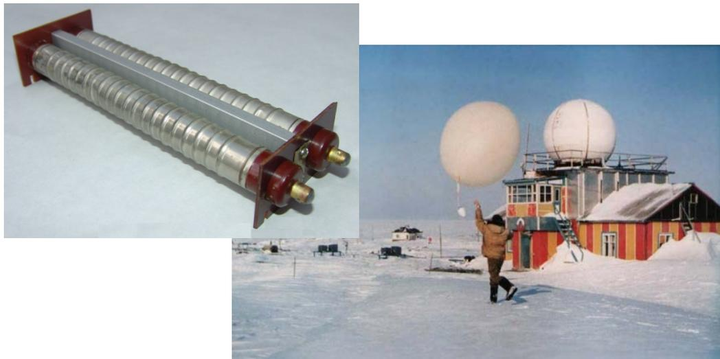
Датчики заряженных частиц радиозонда газоразрядный счетчик СТС-6 и телескоп на их основе. Запуск радиозонда.
